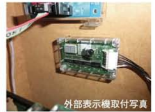
外部表示機取付写真
