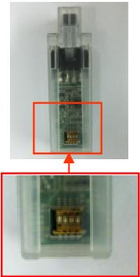
注：「パワフルS」は、サブ基板の電源ラインのショートゴトに対して検知は有効ですが、サブ基板とメイン基板の通信ラインへのショートゴトについてはカバーによる対策が必要です。
